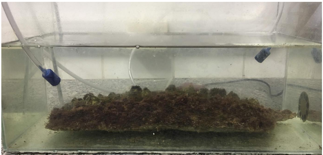
Figura 1 – Aquário de vidro com dimensões 21cm x 44 cm x 27 cm contendo água do mar filtrada (20 \mu m) e pedaço de rocha do costão com aproximadamente 30 cracas adultas Tetraclita stalactifera . A aeração foi garantida por duas bombas de aeração com pedras porosas, que podem ser visualizadas na foto.
